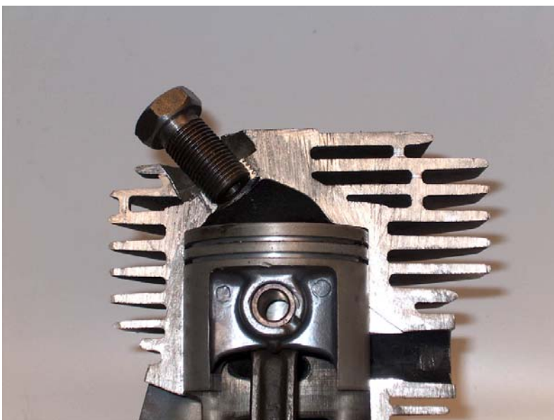
Kuva: Insertti halkaistussa moottorissa oikealla syvyydellä. Huom. insertissä ei ole paikoillaan pysäytin mutteria.
