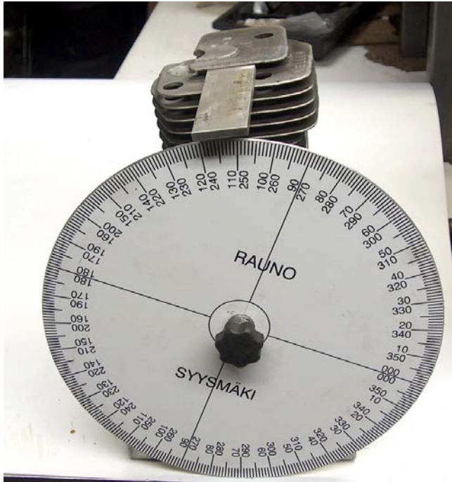
Kuva IMU 3: Astelevy kiinnitettynä kampiakselin päähän.
