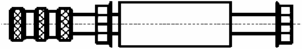
Kuva: Luokituksessa liitteenä esitetty tulpan kierteen pituuden mittausapuväline, joka mahdollistaa katsastamisen nopeasti purkamatta moottoria.
