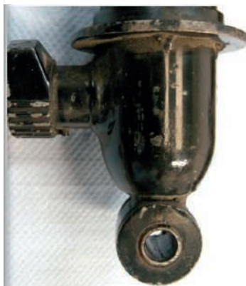
Kuva: Armstrong-vaimennin yhdellä kahteen suuntaan vaikuttavalla säädöllä
