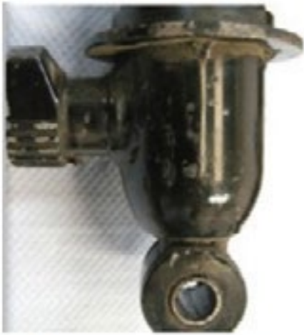
Kuva: Armstrong-vaimennin yhdellä kahteen suuntaan vaikuttavalla säädöllä
