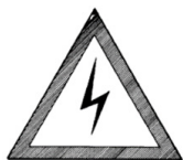
Kuva 9, pääkatkaisijan merkki (punainen salama valkoisella pohjalla ja sinisellä kehyksellä) 100 mm korkeus.
