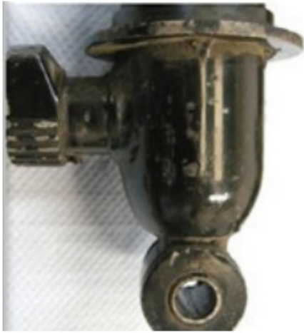
Kuva: Armstrong-vaimennin yhdellä kahteen suuntaan vaikuttavalla säädöllä
