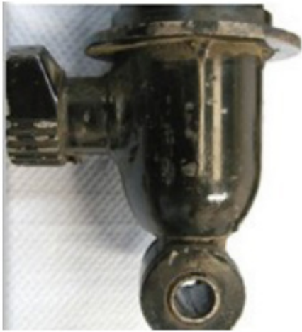
Kuva: Armstrong-vaimennin yhdellä kahteen suuntaan vaikuttavalla säädöllä
