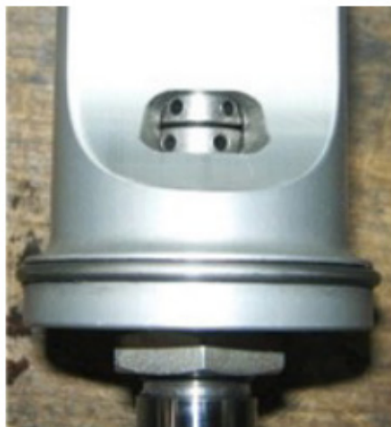
Kuva: Yksiputkivaimennin kahdella säädöllä
